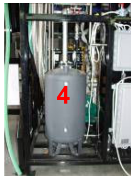
1-PLC remoto 2-Pompa da vuoto ad anello liquido 3-Chiller di raffreddamento remoto 4-Serbatoio olio di riscaldamento 5-Pompa per la circolazione forzata dell'olio
