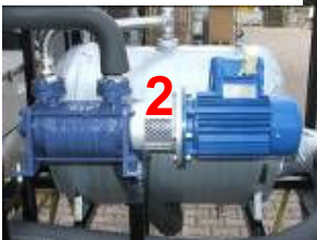
1-PLC remoto 2-Pompa da vuoto ad anello liquido 3-Chiller di raffreddamento remoto 4-Serbatoio olio di riscaldamento 5-Pompa per la circolazione forzata dell'olio
