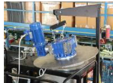
Motoriduttore per la movimentazione delle pale e gru di sollevamento coperchio per manutenzione
