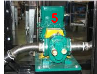
Motoriduttore per la movimentazione delle pale e gru di sollevamento coperchio per manutenzione
